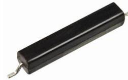
SMD-Reedschalter für Einbruch- und Glasbruchmeldeanlagen
